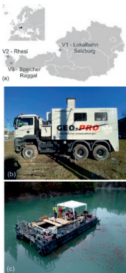
Abbildung 2: a) Lage der Versuchsfelder b) eingesetzter CPT-Truck an V1 und V2 c) Übersicht Schwimmponon an V3
